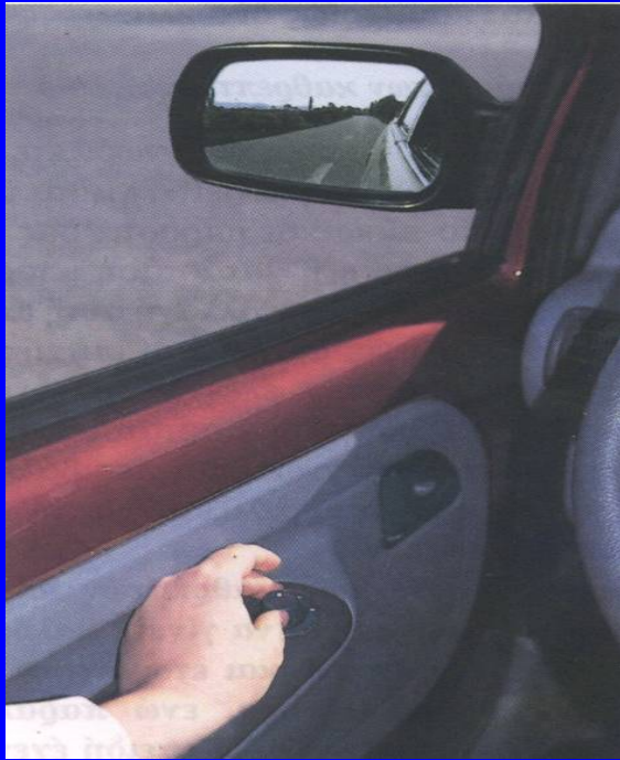
Σχ. 1.21 Ρύθμιση αριστερού εξωτερικού καθρέπτη
